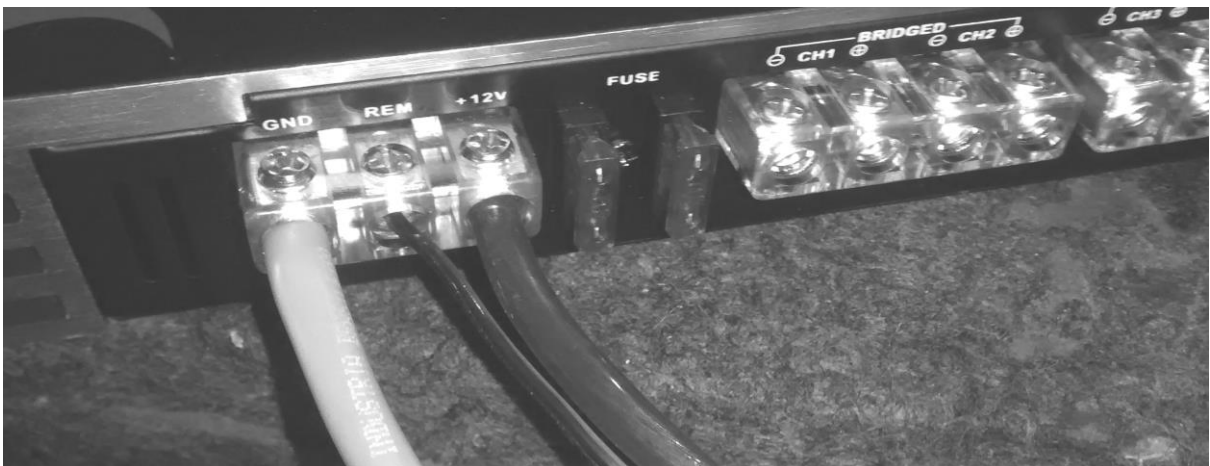
figura 5 - (cabo de alimentação e acionamento para módulo de potência / som automotivo).
